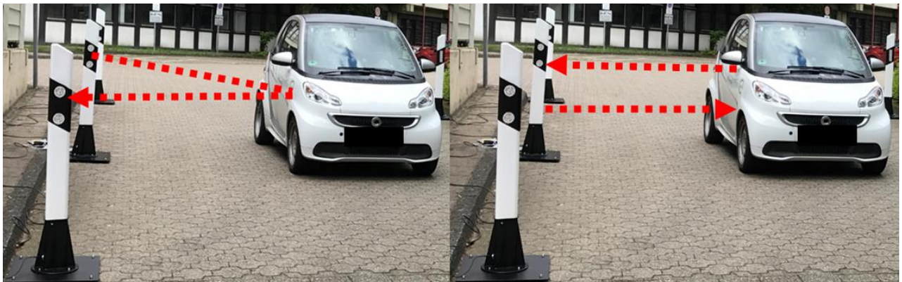
Abbildung 54: Messaufbau zur Untersuchung von Signalreflexionen an einer Straßenseite zwischen zwei Leitpfosten (links) und von Signalreflexionen mit nur einem Leitpfosten (rechts)
