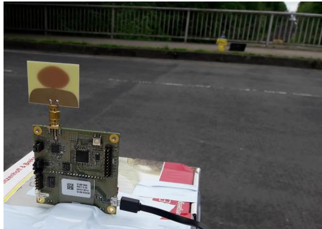
Abbildung 3: Testmessung mit zwei neuen Funkmodulen gleichen Typs über eine Straße
