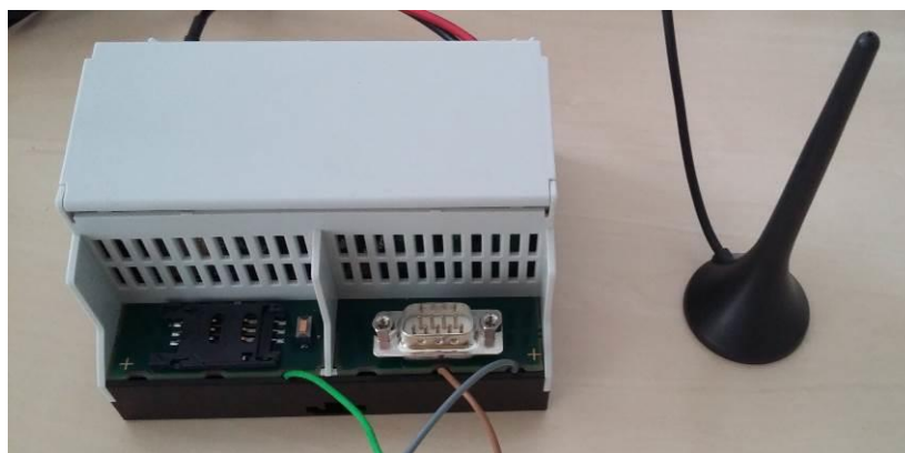
Abbildung 4: Mobilfunk-Modul der Firma contech mit GSM-Antenne
