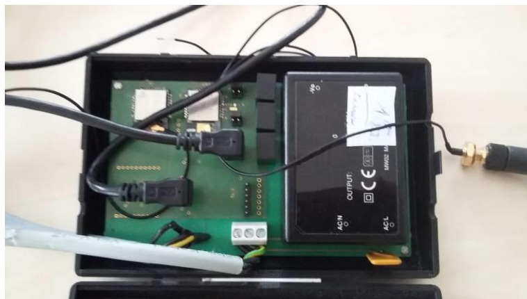
Abbildung 16: Erste Iteration der funkbasierten Sensor-Hardware
