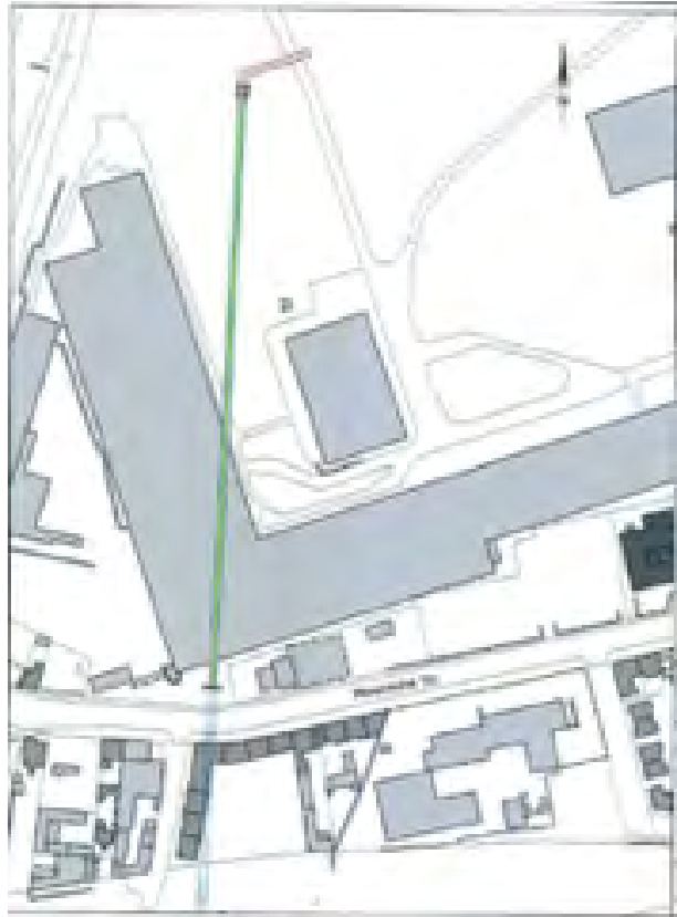
Abbildung 44: Lageplan mit Darstellung der Teilverfüllung des Hahnenmühlenstollens
