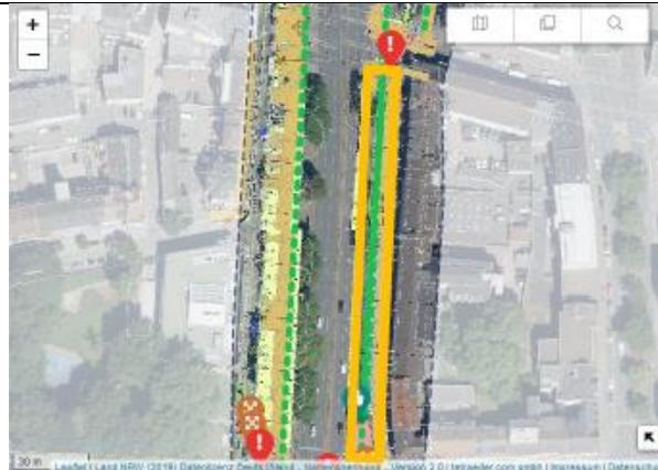
Der Anregung wird gefolgt. Die Ein- und Ausfahrten für den Kfz-Verkehr sind zur Reduzierung der Geschwindigkeit mit Aufpflasterungen versehen. Der Beginn der Fahrradstraße im Einfahrtsbereich erhält eine Rotmarkierung.
