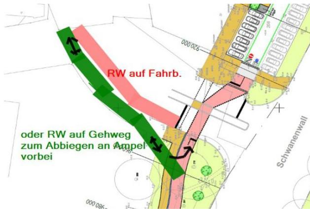
Der Anregung wird gefolgt. Die Planung wurde in diesem Bereich angepasst, so dass der Radfahrer über einen Radfahrstreifen bis kurz vor die Signalanlage geführt und dann auf den Radweg „gehoben“ wird.
